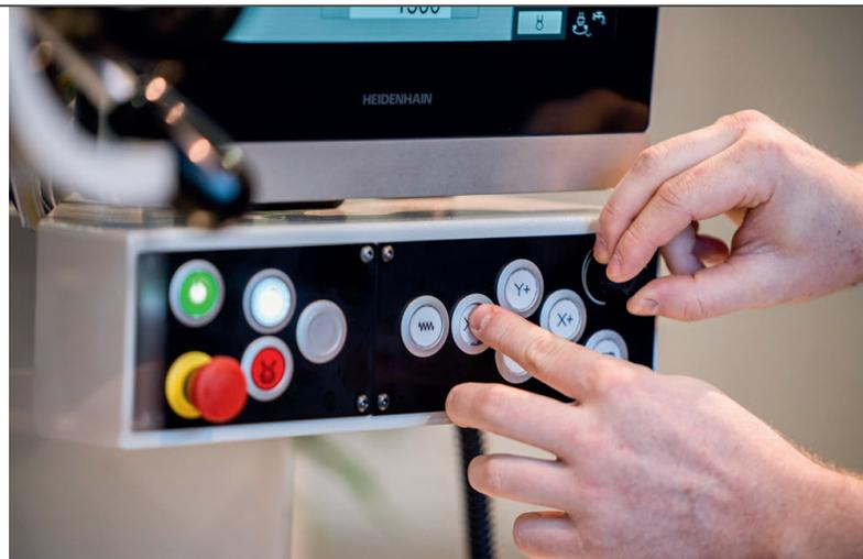
**Sicherheit geht vor:** Jede automatische Bewegung der Fehlmann Picomax 2I-M muss der Anwender per Tastendruck auslösen. © Fehlmann
