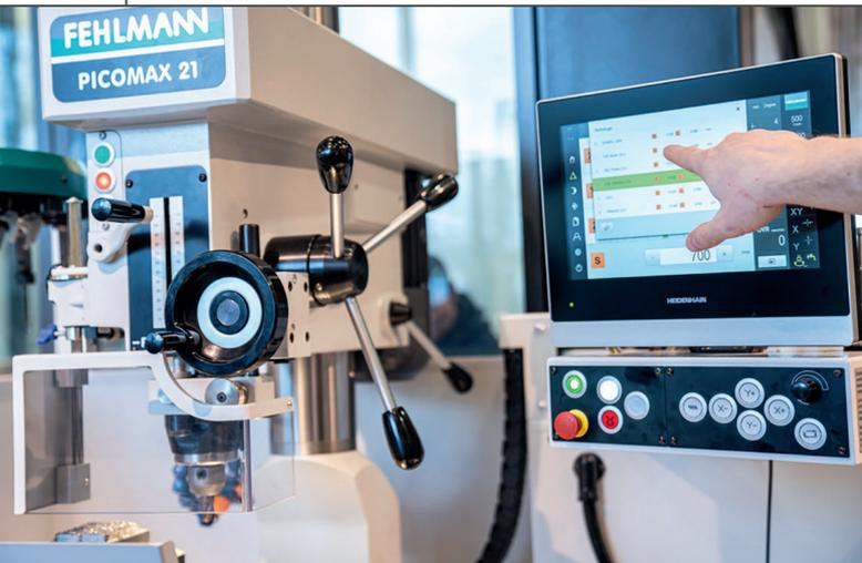
**Intelligente Lösung:** Die handbediente Picomax 2I-M mit Positip 8000 Active ersetzt einfache CNC Maschinen. © Fehlmann
